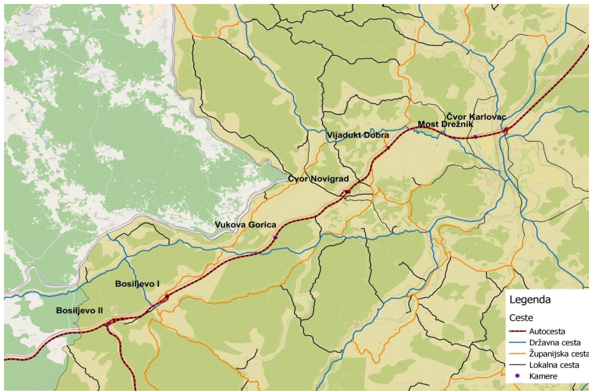
Slika 17. Pozicije kamera za praćenje prometa na autocesti A1/A6 Izvor: Izradio autor temeljem GIS podloga i podataka dionika
